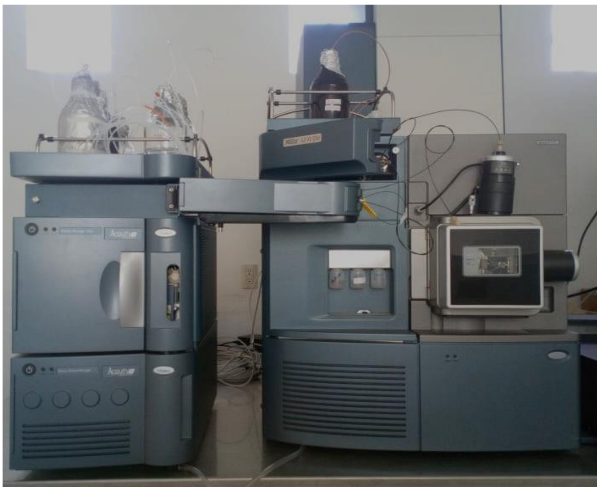
Figura 10 Cromatógrafo Líquido de Ultra-Alta Resolución (UPLC) acoplado a Espectrómetro de Masas (MS)
